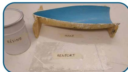
1 Les outils nécessaires : un moule, de la résine et un renfort
